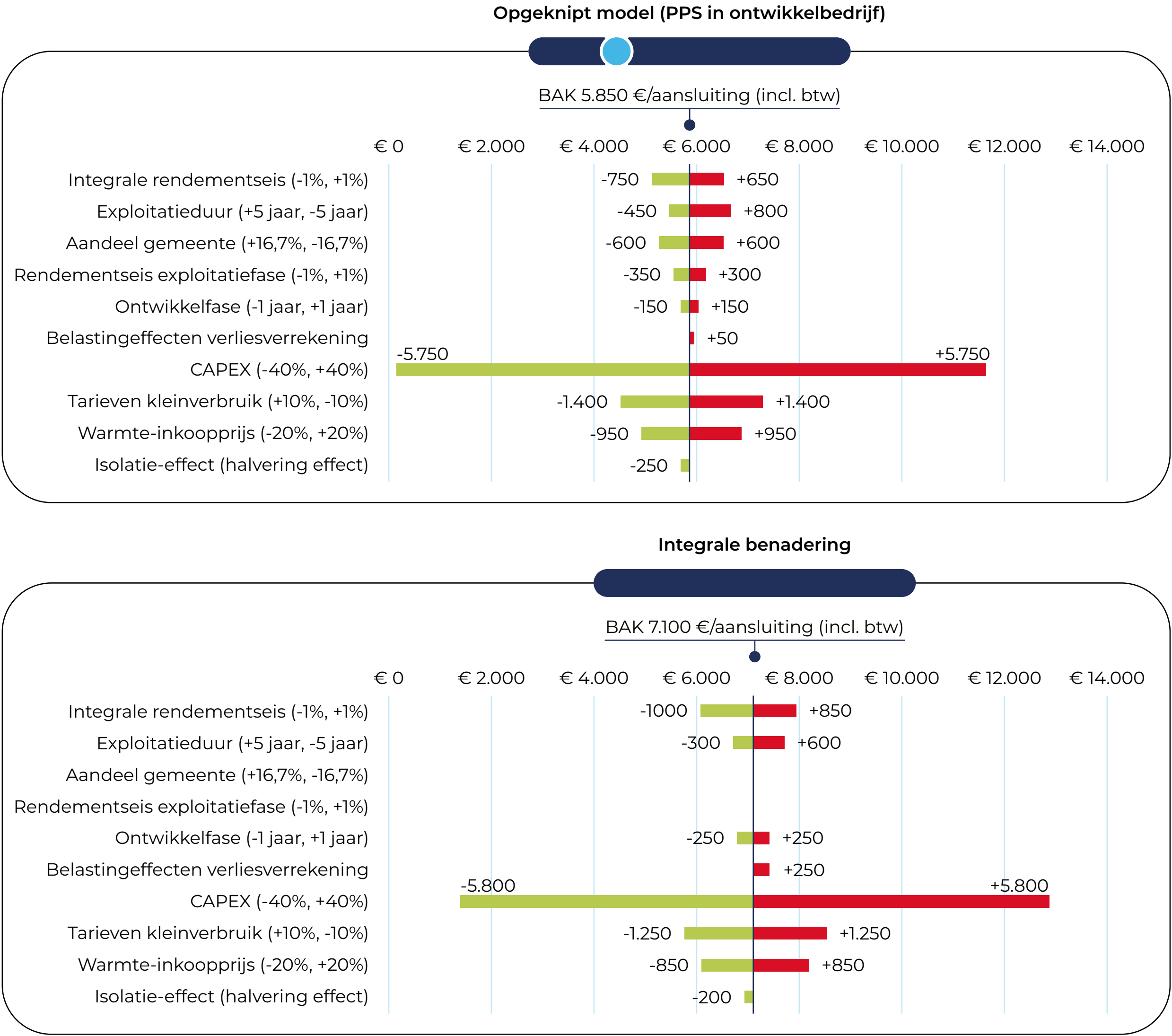
Figuur 4 Gevoeligheidsanalyse, met aan de linkerzijde het opgeknipte model waarin de gemeente participeert in het ontwikkelbedrijf en haar rendement gebruikt om de BAK te verlagen. Aan de rechterzijde het op dit moment veelvoorkomende integrale model met één partij.
