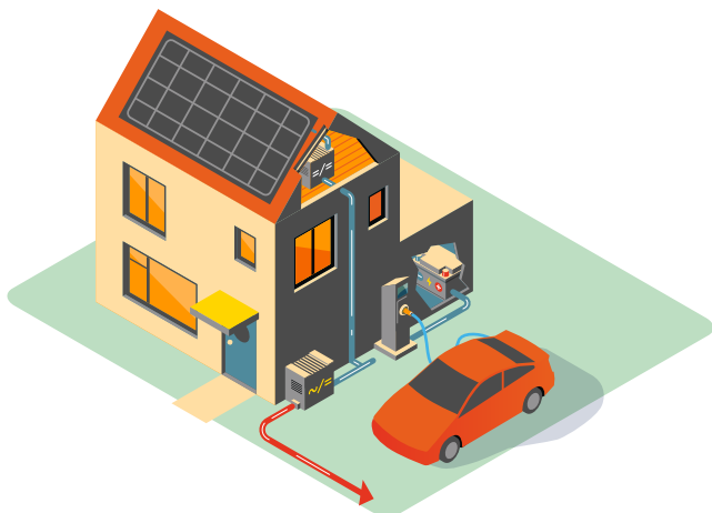
Figuur 1 Lokaal DC microgrid met slimme combinatie zon-PV en V2G
